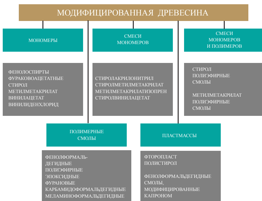
Рис. 2. Структурная схема классификации химических соединений, применяемых для модифицирования древесины
