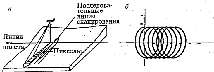
Рис. 78. Схема растрового (а) и конического (б) сканирования (Link, Collins, 1981)
