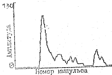
Рис. 9. Образец записи импульса, отраженного от лесного полога, лидаром-батиметром КЦДЗ. По оси у - энергия отраженного импульса, по оси х - время. Левая часть сигнала получена от ближайшего объекта (лесного полога), правая - от более удаленных объектов (напочвенного покрова или поверхности земли (Alfred, Bonnag, 1985)).
