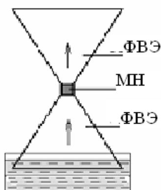
Схема тест-средства для концентрирования определяемого в растворе вещества
