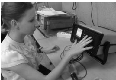
Рис.1. Введение данных на приборе ультразвуковом ГСП УК-1ОПМС
