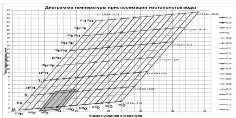
Рис. 2. Диаграмма температуры кристаллизации изотопологов воды. Синим цветом выделена зона стабильных изотопологов
