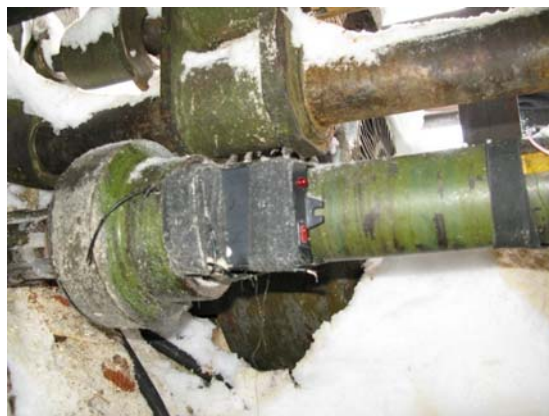
Рисунок 14 – Распиливаемый двукантный брус и установленный акселерометр на синхронизирующем валу механизма резания ЛРВ - 2
