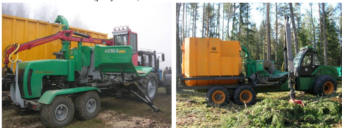
Рисунок 2 – Мобильные барабанные рубильные машины с гидроманипуляторами: а – с приводом от автономного двигателя МР-40 РУП «Минский тракторный завод»; б – с приводом от двигателя форвардера и накопительным бункером Амкодор-2902 ОАО «Амкодор»
