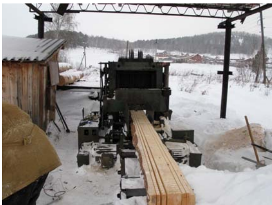
Рисунок 14 – Распиливаемый двукантный брус и установленный акселерометр на синхронизирующем валу механизма резания ЛРВ - 2
