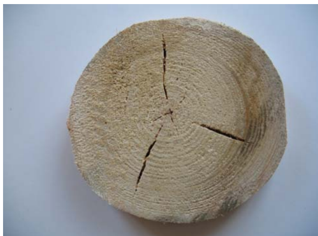
Рисунок 1 – Поперечный срез древесины сосны высушенной по традиционной технологии конвективной сушки
