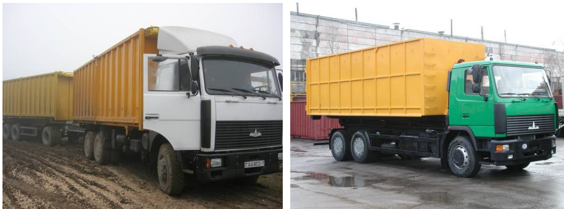
Рисунок 3 – Автомобили для перевозки щепы РУП «Минский автомобильный завод»: а – прицепной автопоезд-щеповоз МА3-5516+МА3-8561; б – автощеповоз с механизмом самозагрузки-разгрузки контейнера типа «мультилифт» МА3-6501
