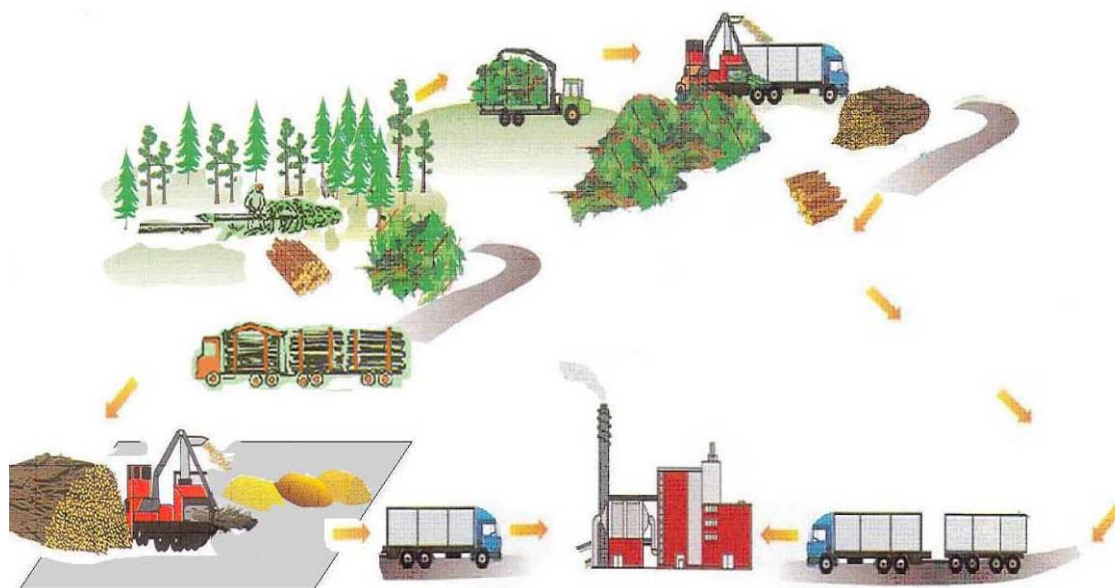
Рисунок 4 – Схема организации технологического процесса производства топливной щепы
