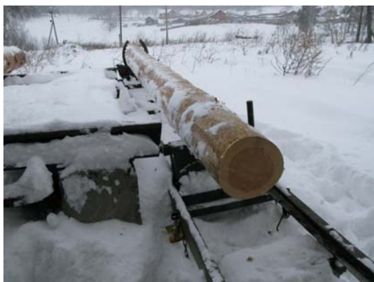
Рисунок 13 – Круглый лесоматериал и лесопильная рама ЛРВ – 2, распиливающая двукантный брус
