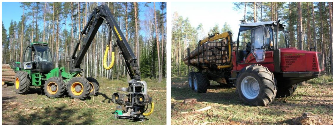
Рисунок 1 – Колесные лесозаготовительные машины: а – харвестер ОАО «Амкодор»; б – форвардер РУП «Минский тракторный завод»
