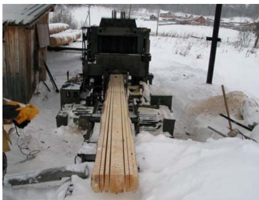
Рисунок 13 – Круглый лесоматериал и лесопильная рама ЛРВ – 2, распиливающая двукантный брус
