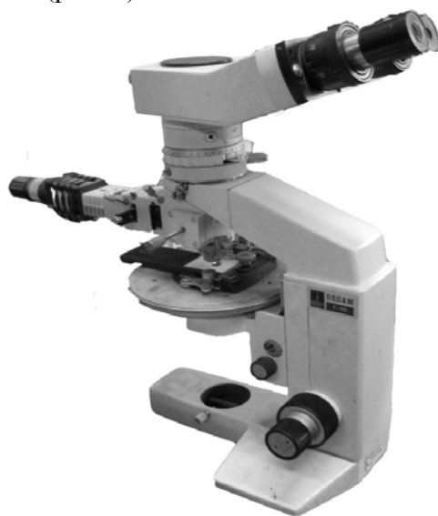
Рисунок 2 – Металлографический микроскоп ПОЛАМ Р-312
