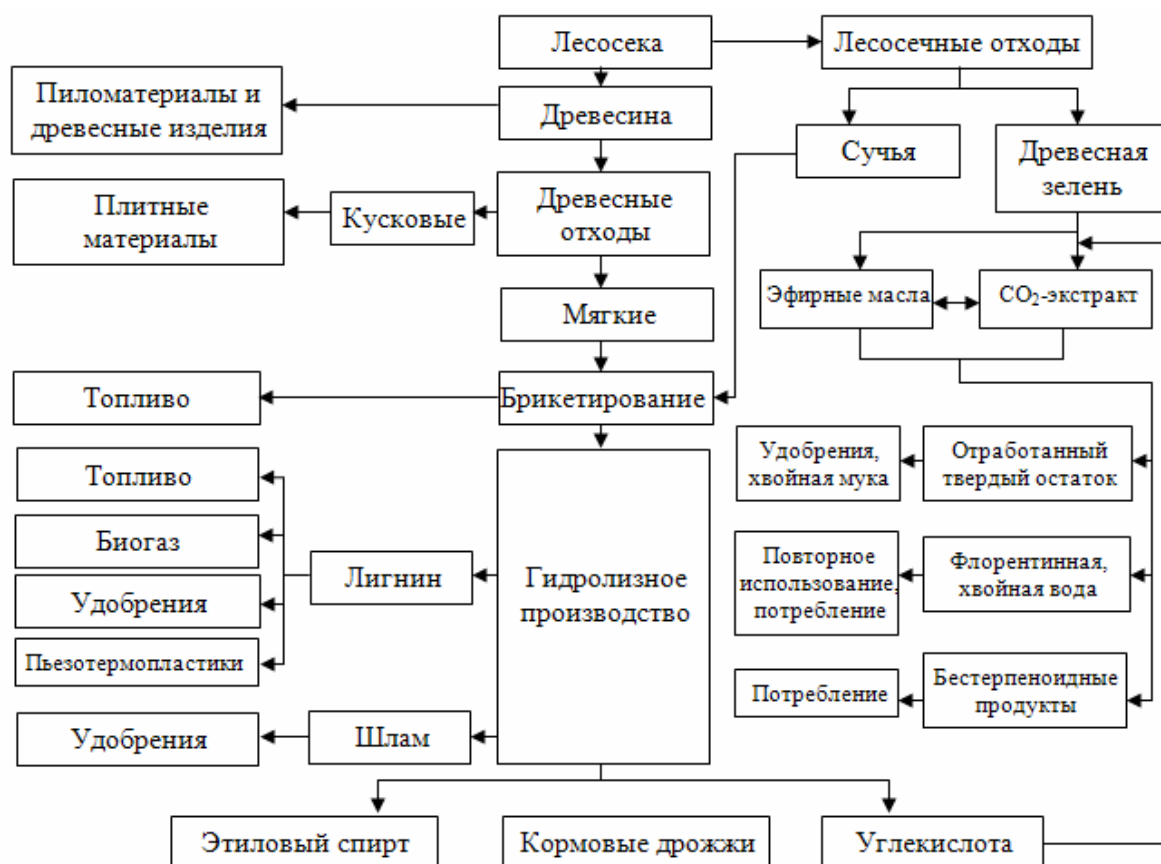
Рисунок 3 – Принципиальная схема переработки мягких отходов в Лесосибирском промышленном комплексе
