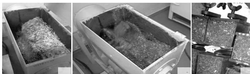
а – осмоление стружки жидким стеклом; б – смешивание раствора арболита; в – формование образцов в разъемных формах
