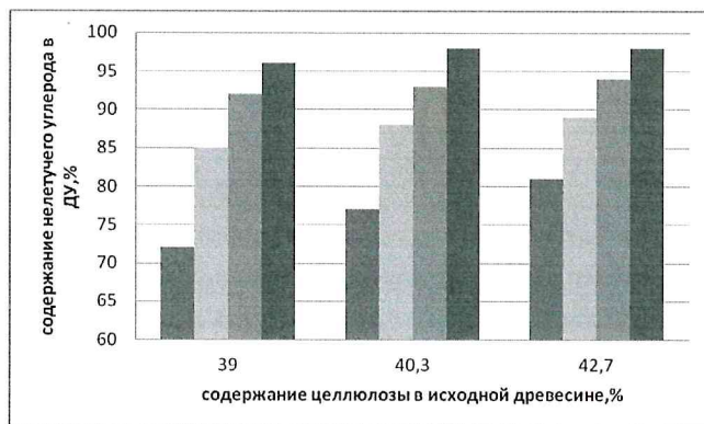
Рисунок 3.13. Зависимость содержания нелетучего углерода в ДУ от содержания целлюлозы в исходной древесине
