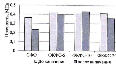
Рисунок 2- Прочность ДСтП с ФС при разрыве перпендикулярно к пласти
