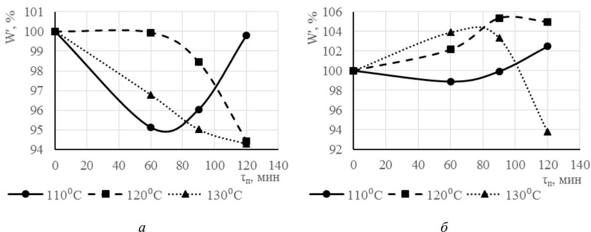
Рис. 6. Зависимость поглощения влаги древесиной дуба (а) и ольхи (б) от времени и температуры пропаривания
