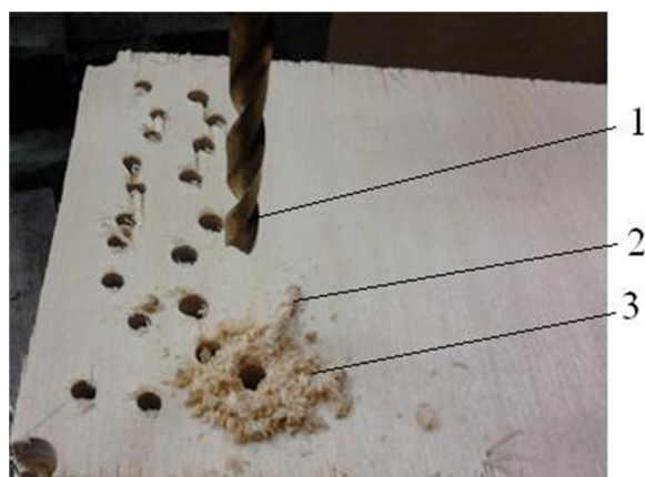
Рис. 2. Сверление заготовок до момента появления брикетов:
