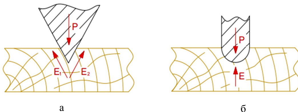
Рис. 1. Форма рельефа пуансона: а – острый, б – скругленный
