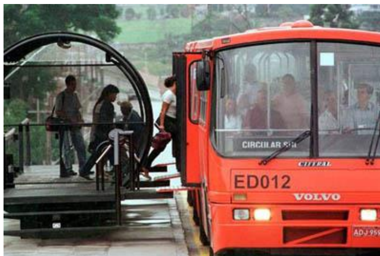
Пример остановочного пункта, оборудованного откидными трапами
