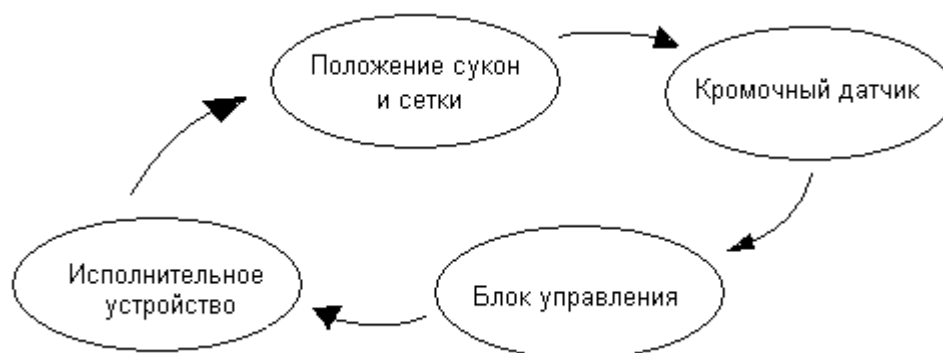
Рис. 1. Принципиальная схема управления правкой сетки или полотна
