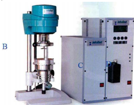
Рис. 3. DSR компании InfraTest: В – реометр, С – управляющее устройство, D – термостат
