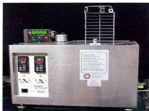
Рис. 2. Прибор искусственного старения при высоком давлении (PAV) 2МПа, температуре 90 °С, 100 °С или 110 °С в течение 20 ч
