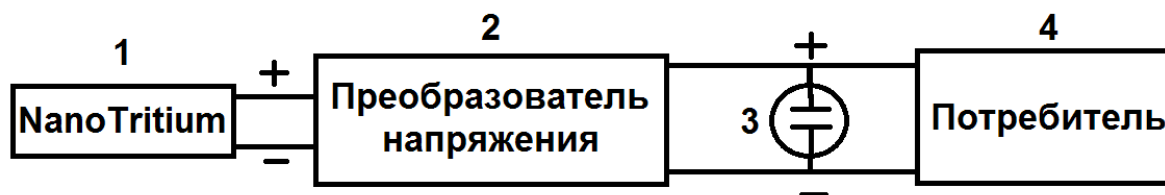
Рис. 4. Структурная схема подключения: 1 – аккумулятор, 2 – преобразователь напряжения, 3 – ионистор, 4 – потребитель
