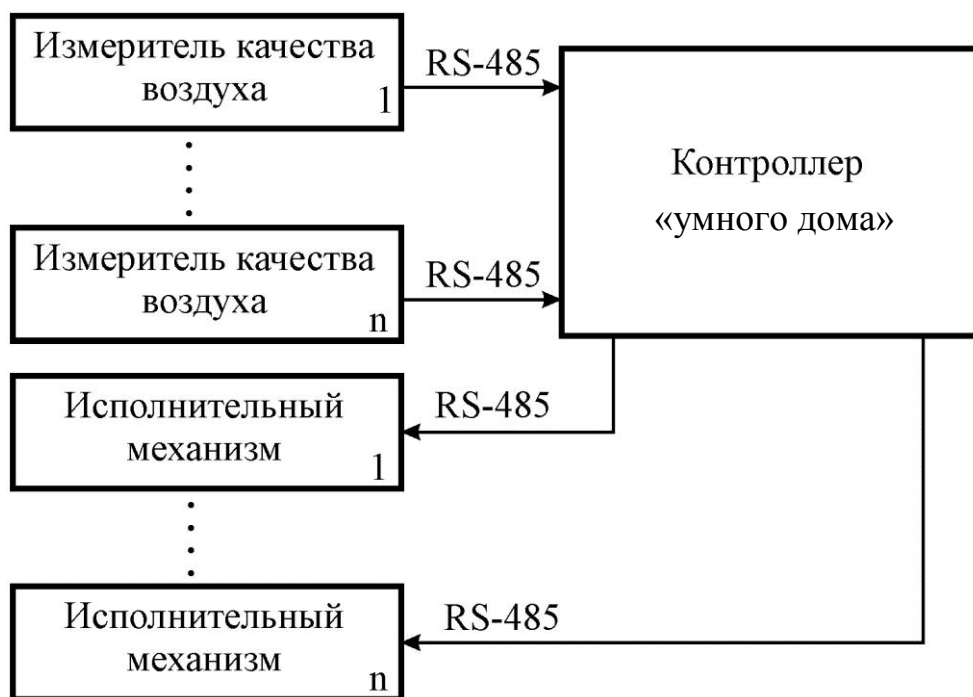
Рис. 2. Структурная схема системы «умный дом»
