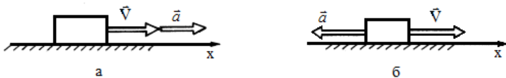
Рис. 2. Направление скорости \vec{v} и ускорения \vec{a} тела при поступательном ускоренном (а) и замедленном (б) движениях
