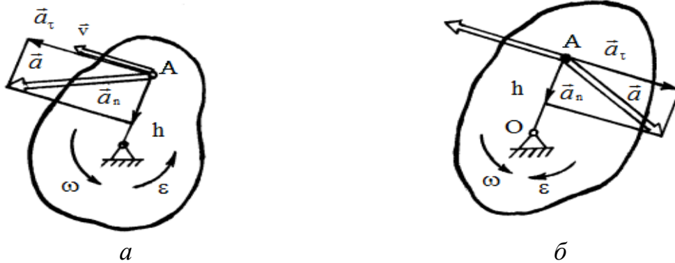
Рис. 3. Скорость и ускорение точки тела при вращательном ускоренном (а) и замедленном (б) движениях
