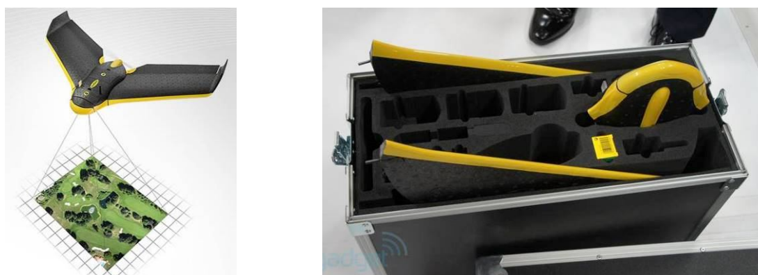
Рис. 4.4. Беспилотник «Эбби» в работе (слева) и в разобранном состоянии в кейсе (справа) ( http://the-clu.com/2013/01/13/6964/ebee2011-10-1522-31-20800 )
