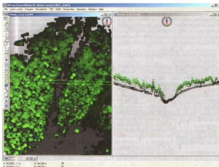
Рис. 4.12. Синтезированные лазерно-локационные изображения структуры лесного покрова и рельефа местности в формате представления лесорастительных и топографических данных программного комплекса Altaxis 2.0 (Данилин, Фаворская, 2011)
