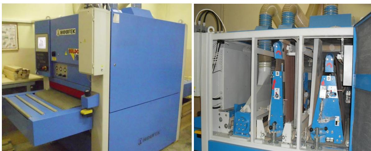
Рис. 1. Станок модели Houfek Bulldog Brick FRC-910
