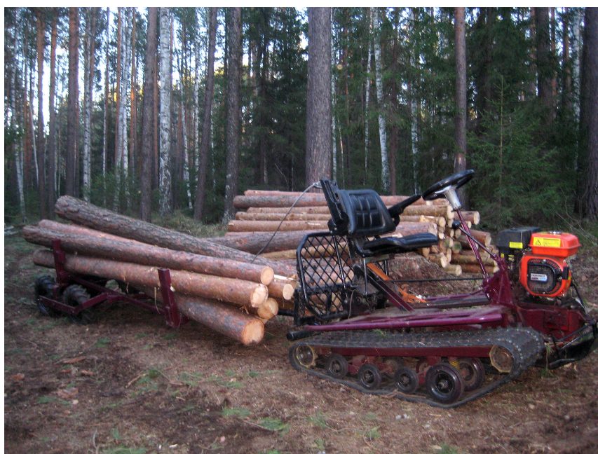
Рис. 2. Транспортировка 3-метровых сортиментов мини-трактором МТР-1
