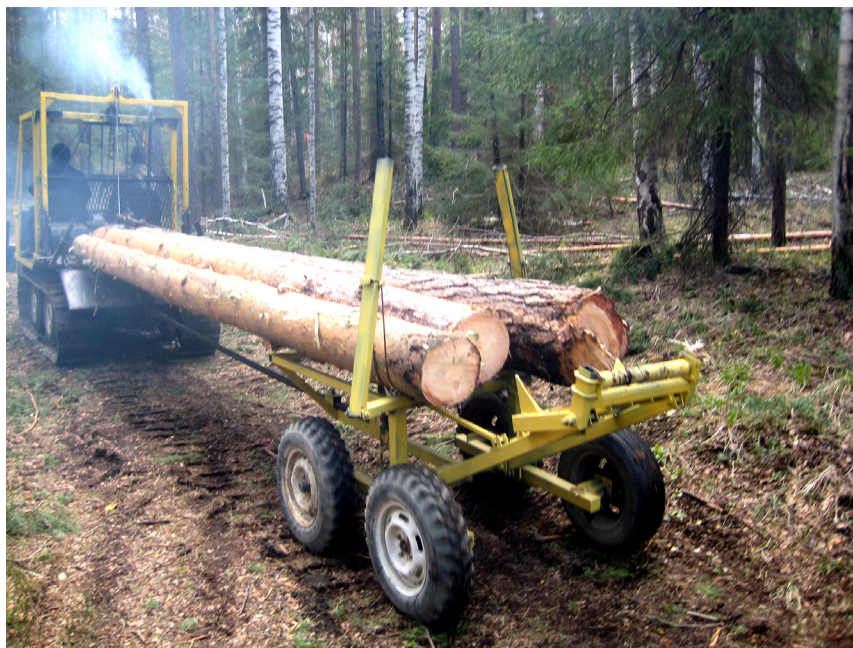
Рис. 3. Транспортировка 6-метровых сортиментов малогабаритным трактором ЛМТ-1
