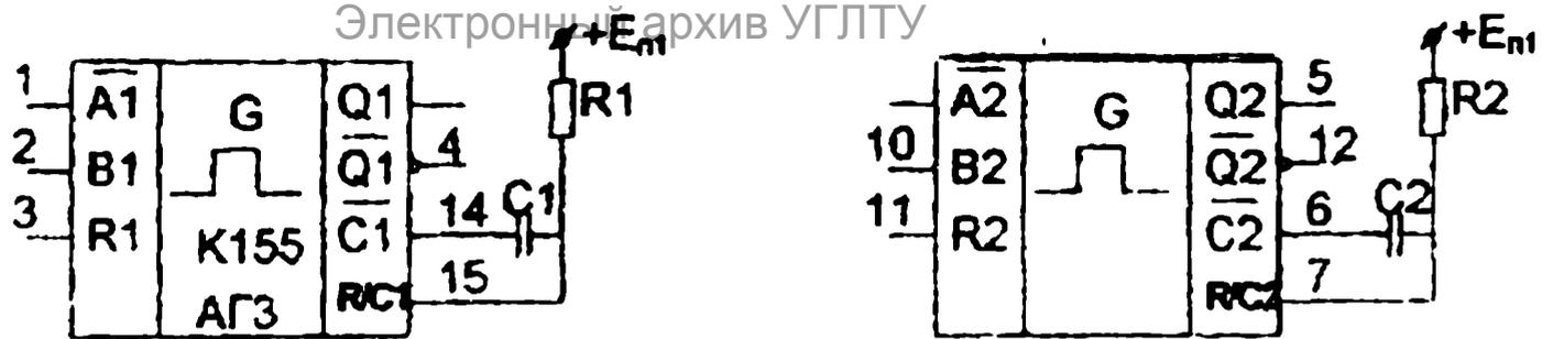
Рис. 4. Условное графическое обозначение микросхемы разнесенным способом
