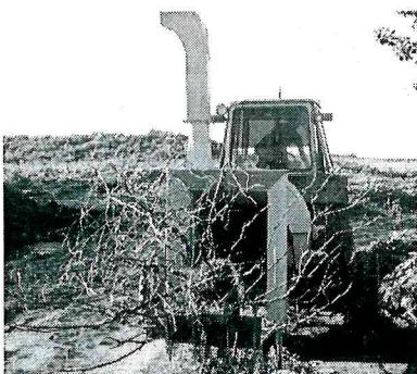
Рисунок 7- Общий вид опытного образца машины для измельчения порубочных остатков (вид сзади)
