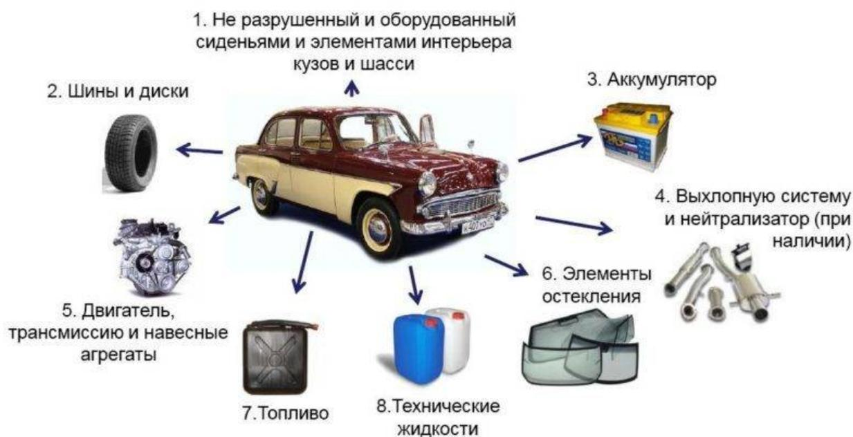
Рис. 1. Комплектация утилизируемого автомобиля
