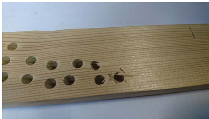
Рис. 3. Качество поверхности на выходе сверла из отверстий
