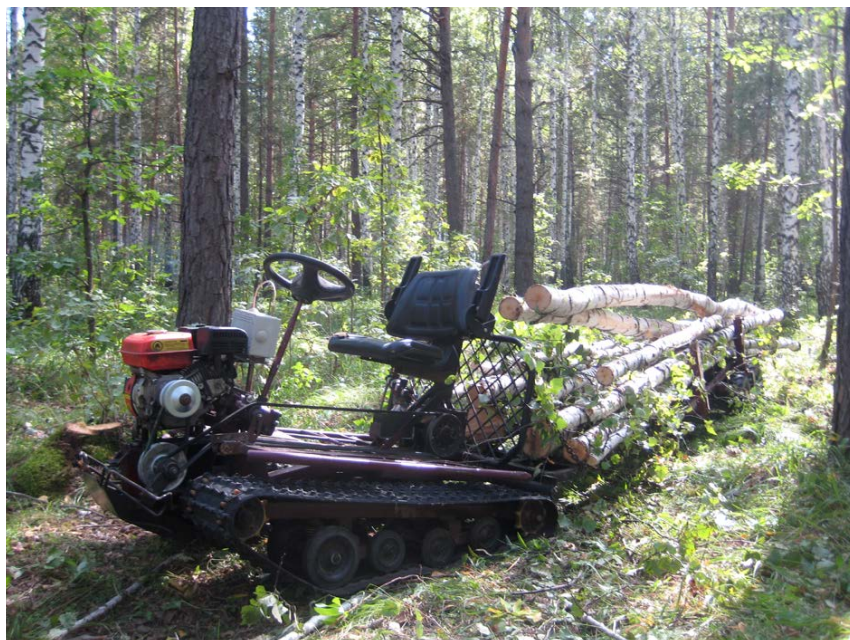
Рис. 3. Трелевка мини-трактором 6-метровых сортиментов между рядами культур дуба
