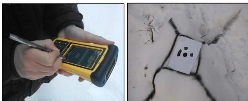
Рис. 1. GPS-навигатор и опорная точка
