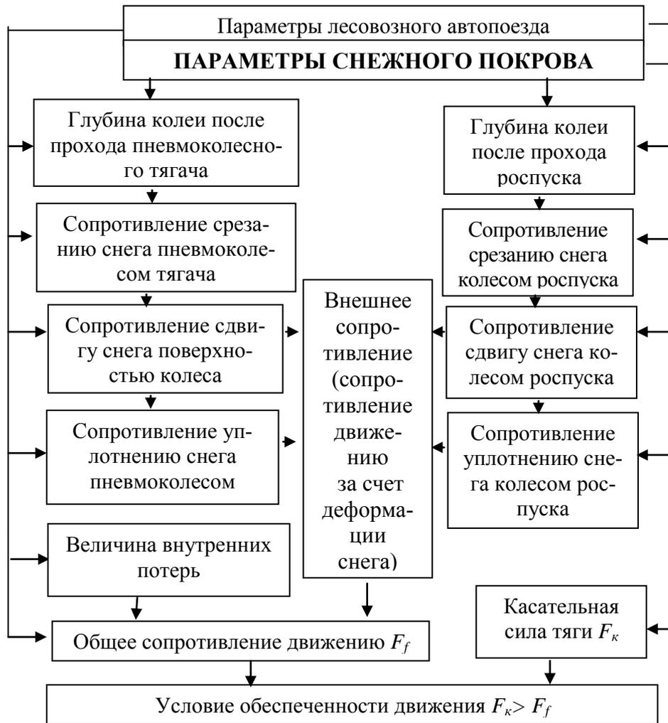
Рис. 1. Структурная схема математической модели взаимодействия лесовозного автопоезда со снежным покровом
