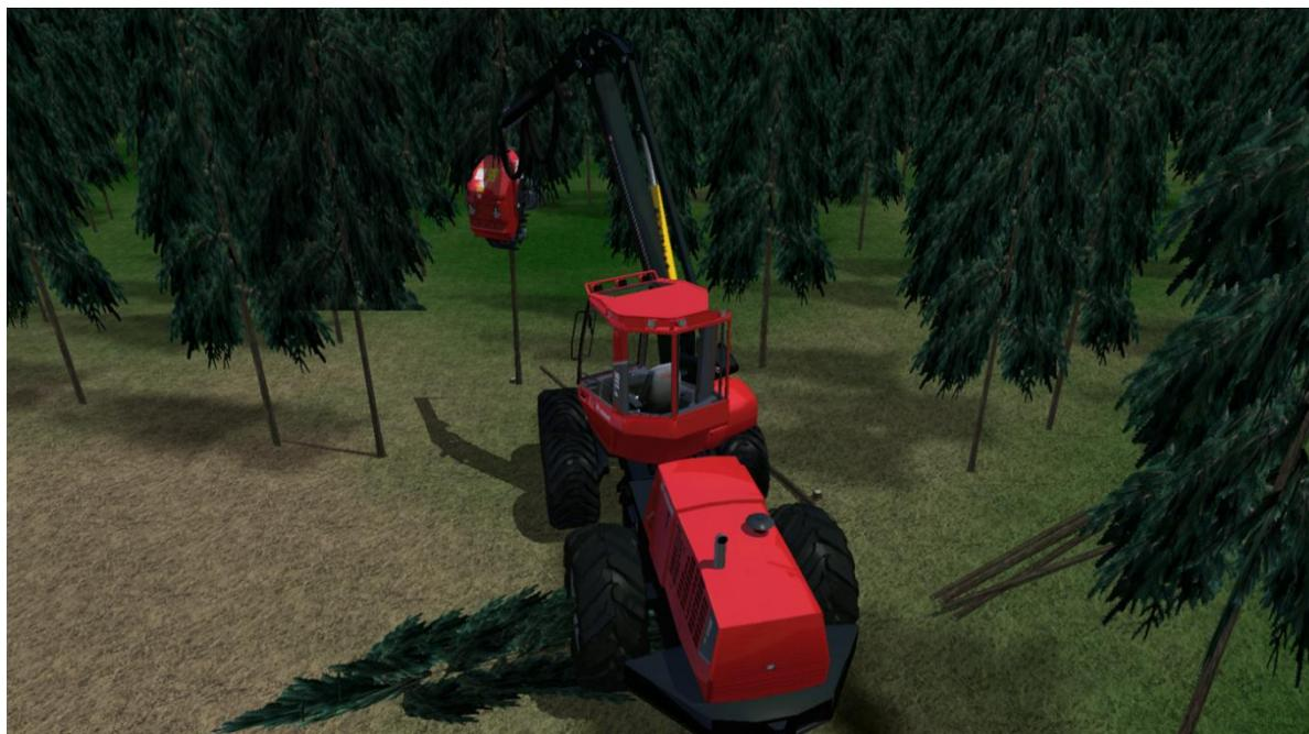
*Рис. 3.* Экранная копия заготовки сортиментов харвестером в вертикальном положении обрабатываемого дерева в ходе имитационного эксперимента
