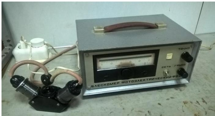
Рис. 2. Фотоэлектрический блескомер ФБ-2
