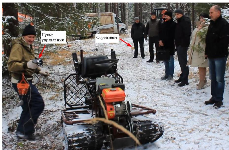
Рис. 3. Общий вид мини-трактора с дистанционным управлением
