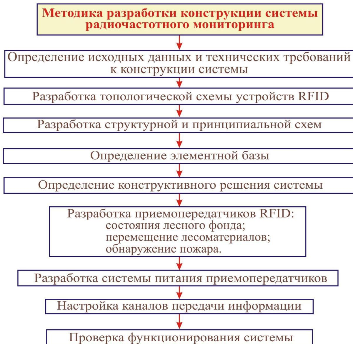
Рис. 1. Схема методики проектирования системы мониторинга
