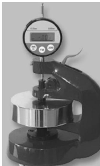
Рис. 6. Лабораторный прибор для измерения толщины бумаги
