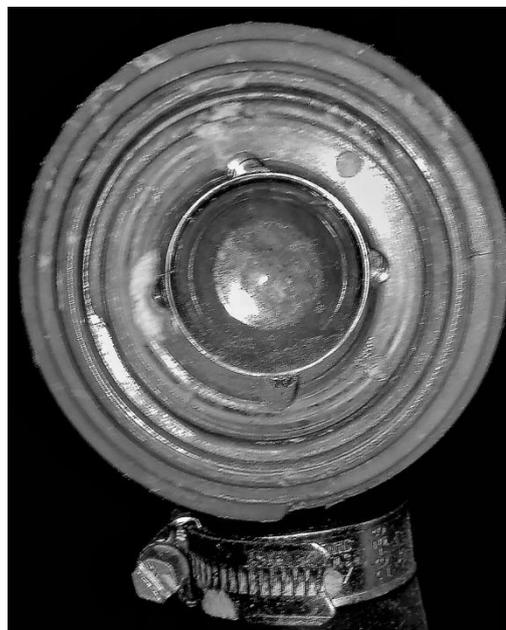
*Рис. 3.* Отсутствие следа от вакуумного столба при ненормальной работе вихревого очистителя
