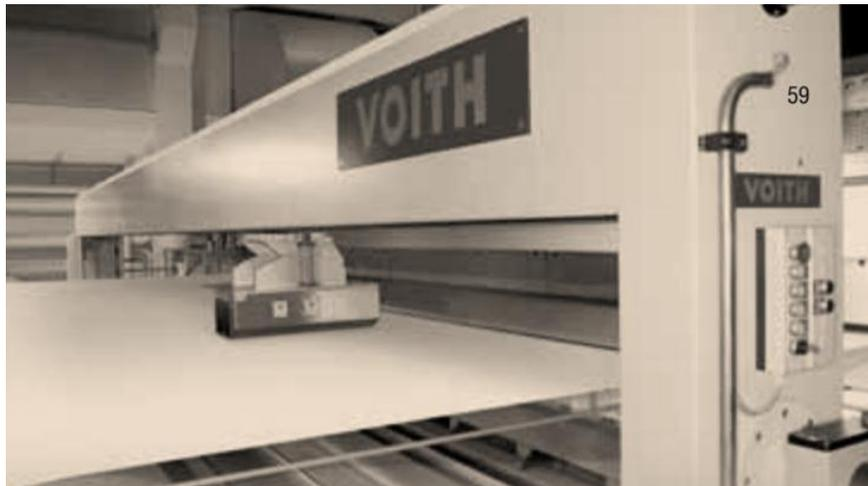
Рис. 2. Сканер на бумагоделательной машине
