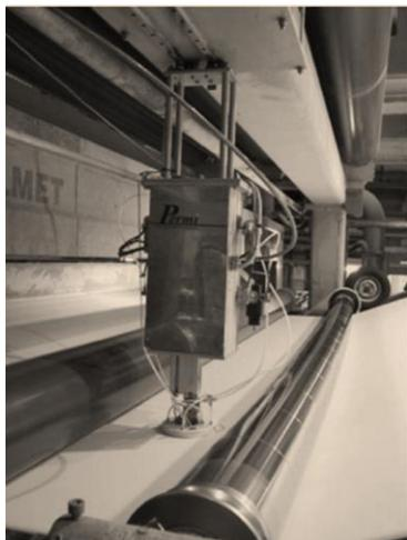
Рис. 1. Датчик воздухопроницаемости
