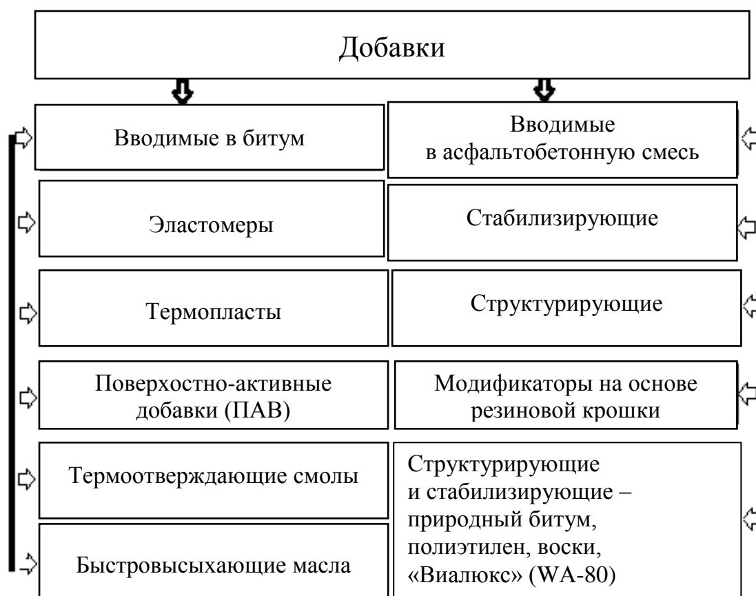
Классификация добавок к битуму и асфальтобетонным смесям в дорожном строительстве
