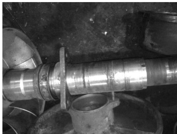
Рис. 2. Выработка в местах установки сальников
