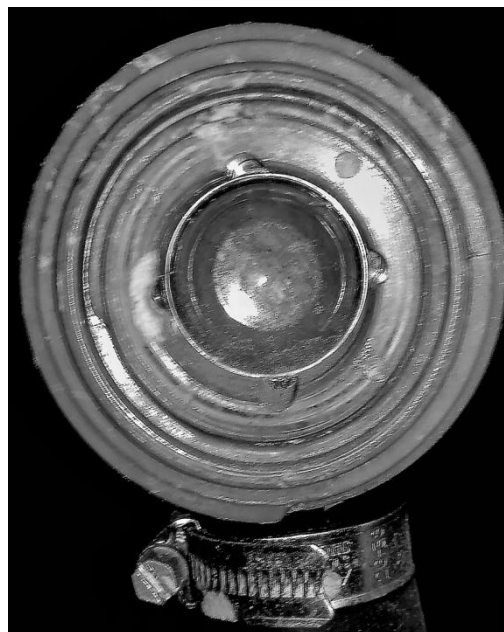
Рис. 3. Отсутствие следа от вакуумного столба при ненормальной работе вихревого очистителя
