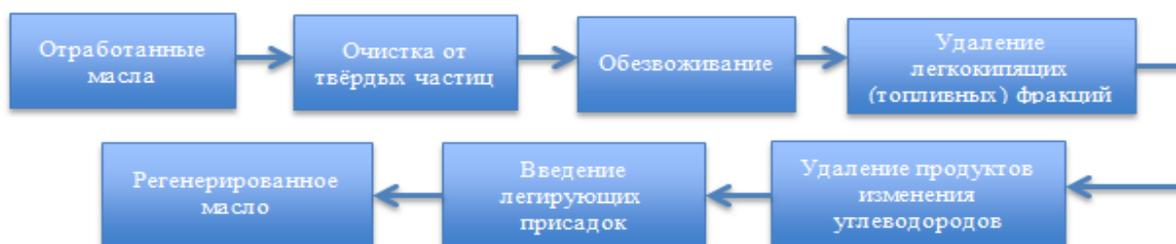
Рис.1. Физико-химический метод очистки отработанных масел
