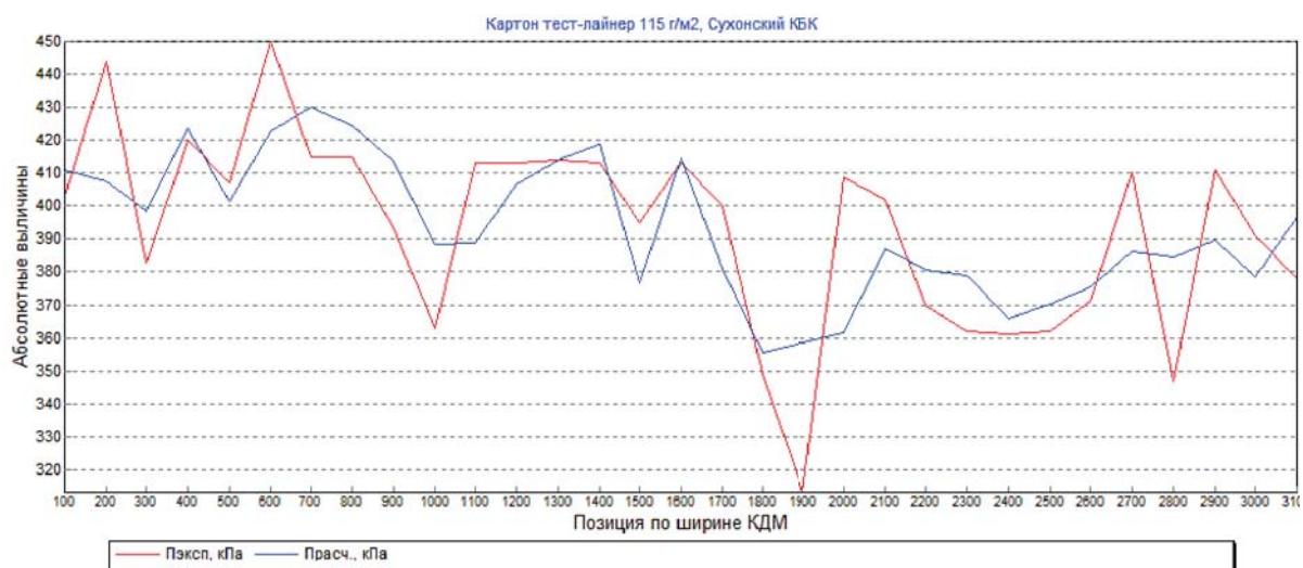
Рис. 3. Экспериментально измеренный и расчетный профиль тестлайнера по сопротивлению продавливанию
