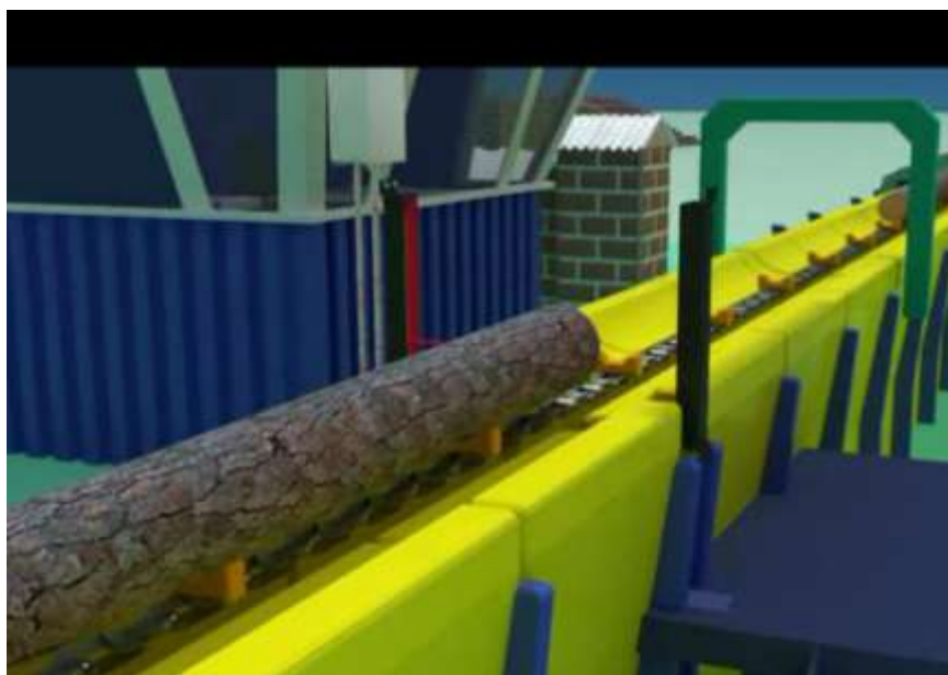
Рис. 32. Линия сортировки бревен с одноплоскостным сканером
