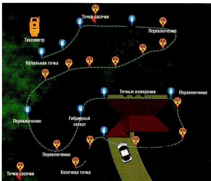
Рис. 2. Пример выполнения геодезических съемочных работ по технологии «Гибрид»
