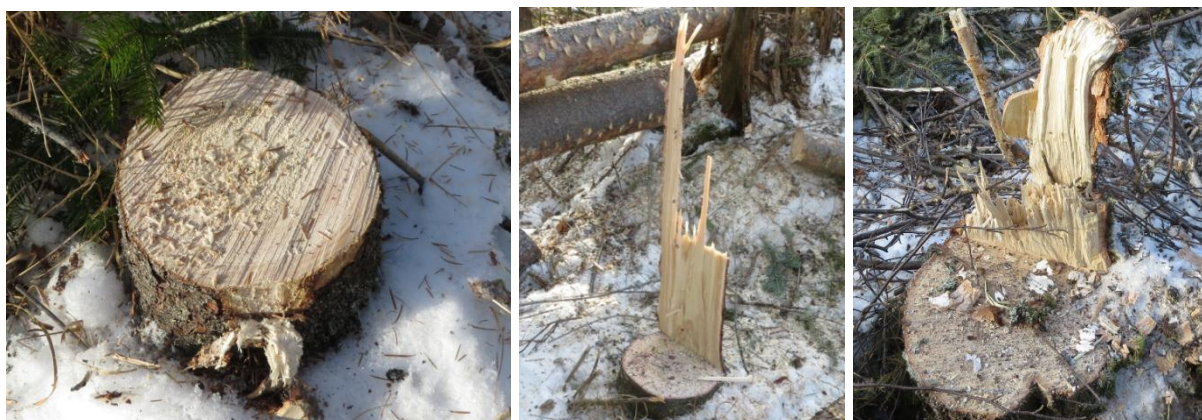
Основные дефекты обработки заготавливаемой древесины харвестером: а – валка дерева без повреждений; б – отщеп, скол; в – вырыв
