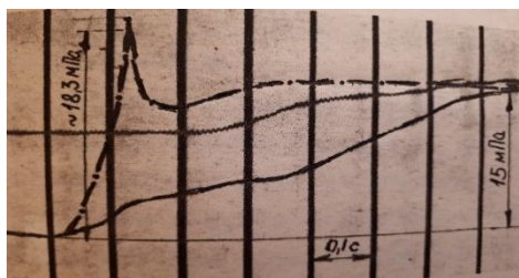
Рис. 4. Давление в ГЦ с демпфером и без
