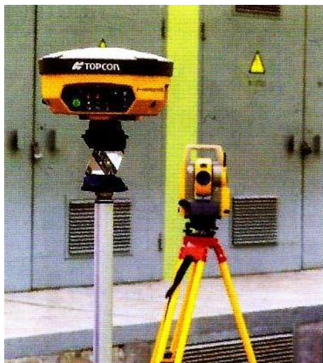
Рис. 1. Аппаратура, используемая в технологии «Гибрид»: приемник ГНСС и роботизированный электронный тахеометр
