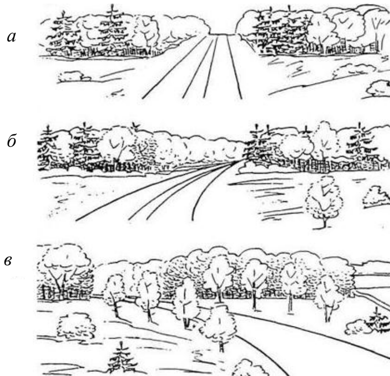
Рис. 1. Особенности проектирования автомобильных дорог на участках входа в лесной массив: а – прямолинейное пересечение леса; б – вход в лес на кривой; в – посадка деревьев и кустарников на входных участках
