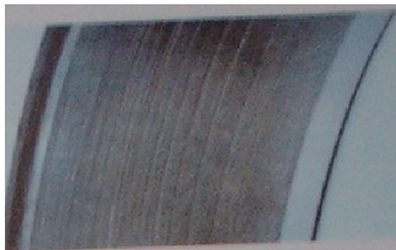
Рис. 3. Абразивный износ по окружности дорожки тел качения
