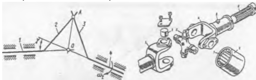
Рис. 9. Слева - схема карданного шарнира равных угловых скоростей (1 - ведущий вал, 2, 3 - рычаги, 4 - ведомый вал), справа - карданный шарнир неравных угловых скоростей (1, 4 - вилки, 7 - корпус, 3 - крестовина, 5 - масленка, 6 - шлицевое соединение, 7 - игольчатые подшипники)
