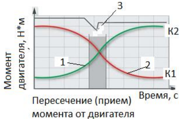
Рис. 21. Изменение направления силового потока: 1 – включаемое сцепление; 2 – выключаемое сцепление; 3 – вмешательство в момент двигателя
