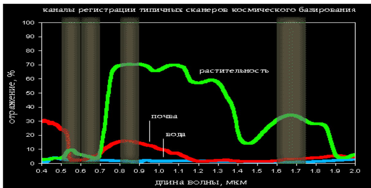
Рис. 1. Поглощение и отражение объектами ЭМ излучения
