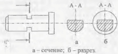
Рисунок 5 – Отличие разреза от сечения
