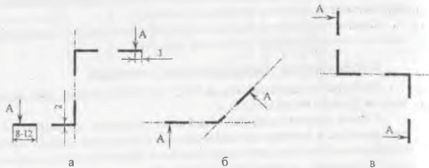
Рисунок 4 – Способы отметки сложных разрезов на чертеже
