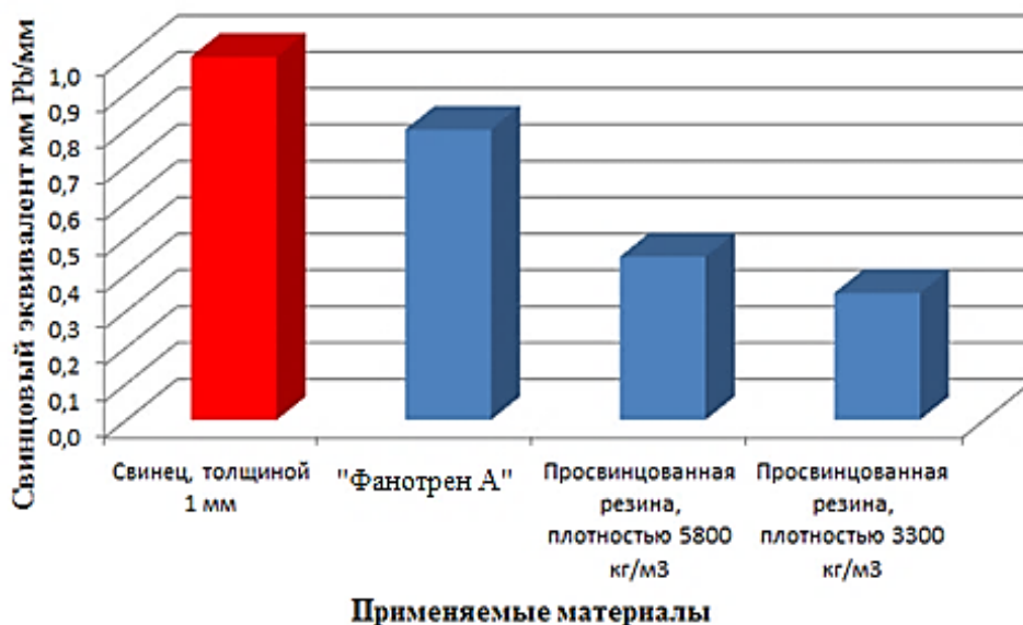
Рис. 3. Значение свинцовых эквивалентов свинца толщиной 1 мм (эталон); просвинцованной резины разной плотности и материала «Фанотрен А»
