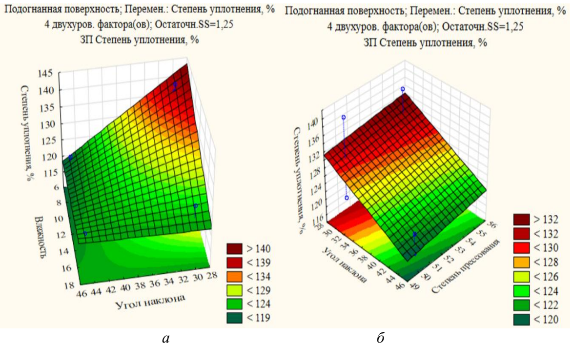
Рис. 6. Подогнанные поверхности степени уплотнения при фиксированных значениях: а – \varepsilon = 52,5\% , T = 165\text{ }^\circ\text{C} ; б – W = 12\% , T = 165\text{ }^\circ\text{C}
