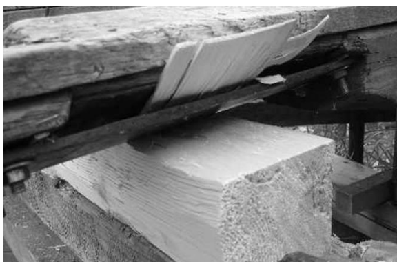
Рис. 6. Способ продольного строгания дранки
