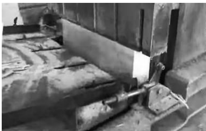
Рис. 3. Положение стопы заготовок при поперечном строгании
