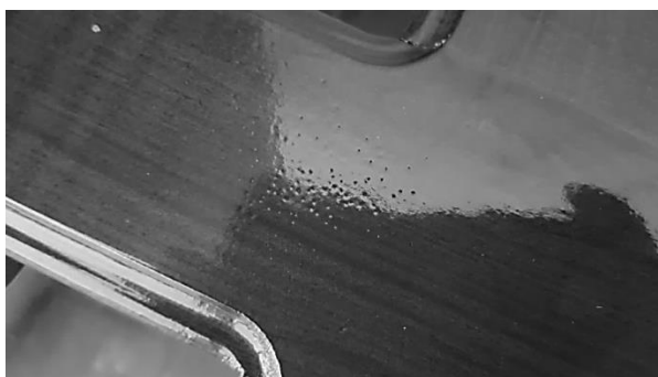
Рис. 2. Шагрень на лакокрасочном покрытии
