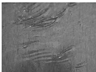
Рис. 4. Сморщивание лакокрасочного покрытия
