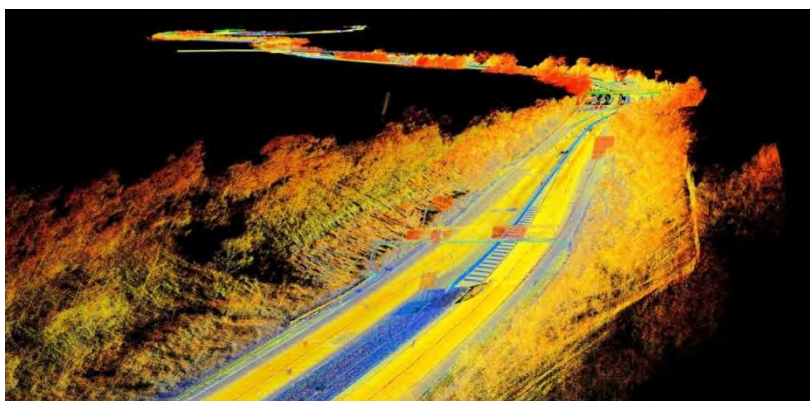
Рис. 2. Пример результата съемки автомобильной дороги лазерным сканером
