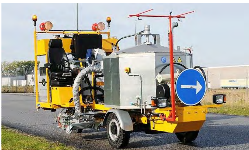
Самоходная разметочная машина RME RMS-550
