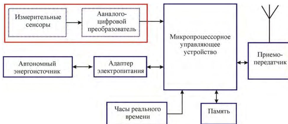
Рис. 3. Структурная схема RFID-сенсора (узел беспроводной сети)
