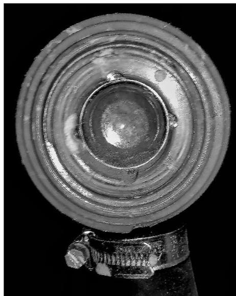
*Рис. 2.* На заглушке вихревого очистителя с повышенной вибрацией следа от вакуумного столба нет
