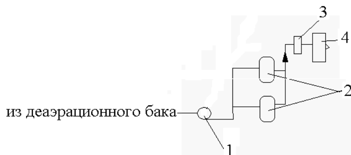
Рис. 1. Фрагмент короткой линии циркуляции массоподводящей системы бумагоделательной машины №3 АО «Соликамскбумпром»
