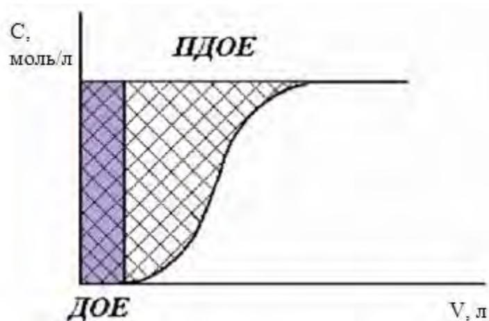
Рис. 2. Определение полной обменной емкости
