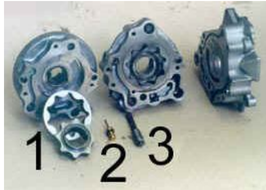
Рис. 15. Передний масляный насос – 1; 2 – термоклапан; 3 – редуциционный клапан
