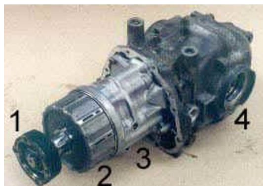
Рис. 8. Механизм привода задних колес со снятой передней частью корпуса:
