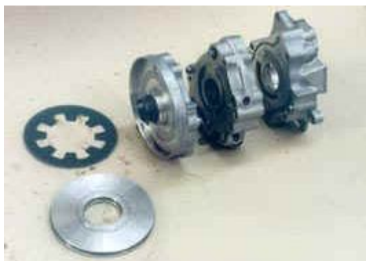
Рис. 13. Гидравлическая часть состоит из трех «слоев»
