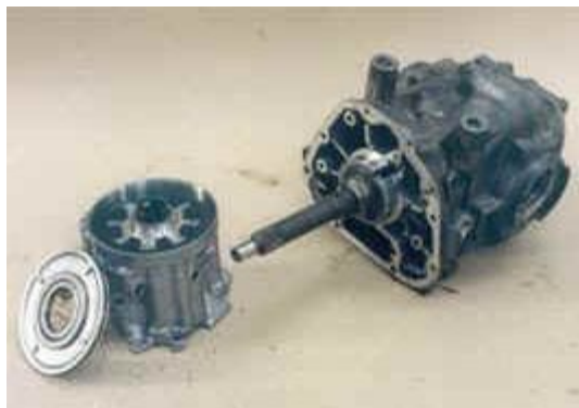
Рис. 12. Гидравлическая часть развернута на 90 градусов по часовой стрелке. Снят поршень привода многодискового сцепления
