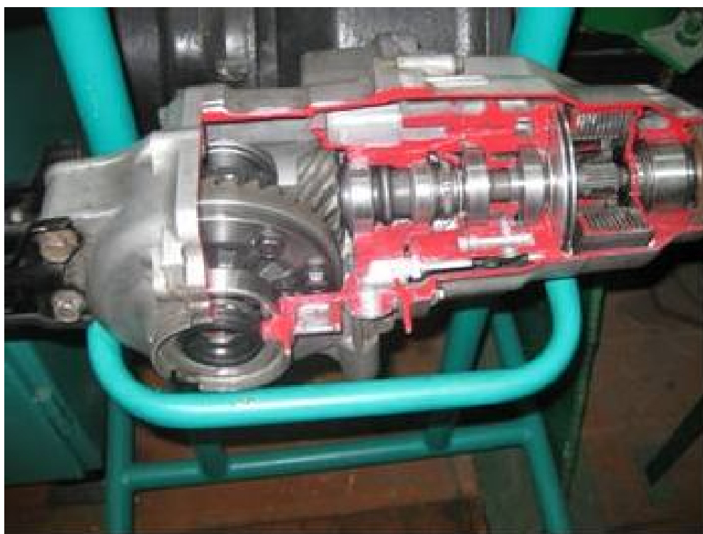
Рис. 3б. Стенд механизма привода задних колес автомобиля CR-V в лаборатории кафедры сервиса и эксплуатации транспортных и технологических машин УГЛТУ
