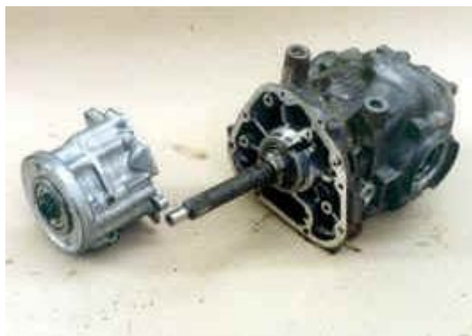
Рис. 11. Гидравлическая часть системы DPS отделена от корпуса дифференциала
