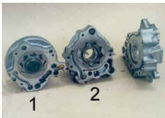
Рис. 14. Первые два «слоя» повернуты на 90 градусов. Виден передний (1) и задний (2) масляные насосы
