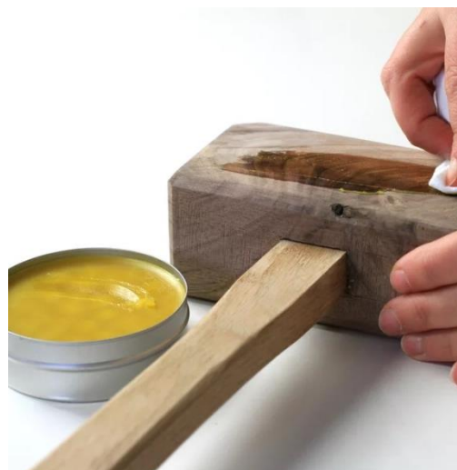
Рис. 6.2. Нанесение воска на киянку
