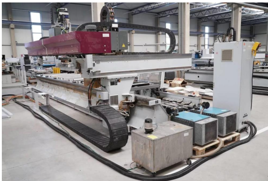
Рис. 5.6. Деревообрабатывающий центр с ЧПУ
