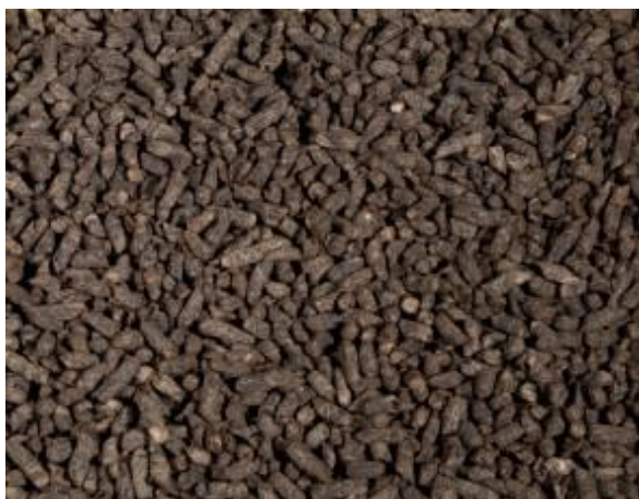
Рисунок 1– Стабилизирующая добавка для ЩМАС Viator 66 на основе целлюлозы
