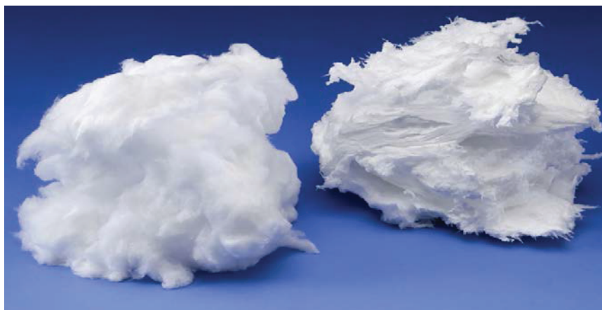
Рис. 4.5. Внешний вид штапельных стеклянных волокон Lauscha Fiber International
